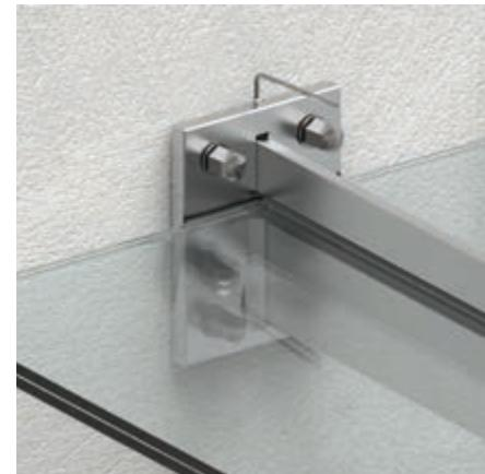
4. Die Befestigungsschrauben so weit hineinschrauben, bis es zu einem Kontakt zwischen oberer Deckleiste und Glasscheibe kommt. Im weiteren Verlauf die Schrauben nur noch so weit anziehen, dass die obere Deckleiste sich in ihrer form (Bogen im mittleren Bereich) nicht verbiegt. Empfehlung: Schrauben abwechselnd anziehen.
