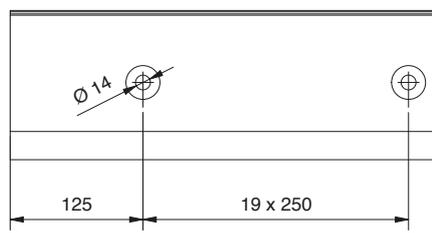
Für die Entwässerung der Profile müssen je nach baulicher Situation die Lochabstände selbst bestimmt und bauseits ins Profil gebohrt werden.
