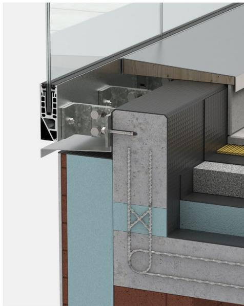
(C) Außenanwendung: Beispiel Balkon-Attika mit Betonelementen gedämmt
