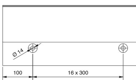
Für die Entwässerung der Profile müssen je nach baulicher Situation die Lochabstände selbst bestimmt und bauseits ins Profil gebohrt werden. For the drainage of the profiles, depending on the structural situation, the hole spacing must be determined by the customer and drilled on site.
