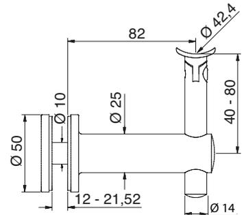
Variabler Handlaufträger | flexible handrail support
