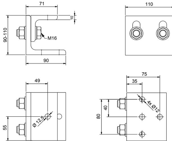
Anzugsmoment | tightening torque M16: 165Nm + 60°
