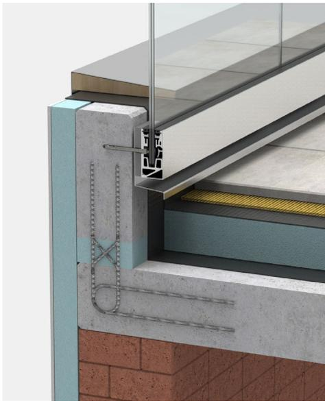
(C) Außenanwendung: Beispiel Balkon-Attika, gedämmt, Profil innen
