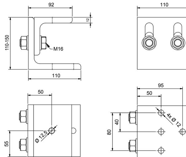
Anzugsmoment | tightening torque M16: 165Nm + 60°
