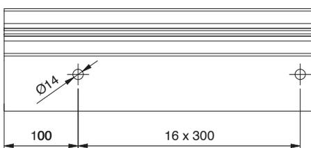
Für die Entwässerung der Profile müssen je nach baulicher Situation die Lochabstände selbst bestimmt und bauseits ins Profil gebohrt werden. For the drainage of the profiles, depending on the structural situation, the hole spacing must be determined by the customer and drilled on site.
