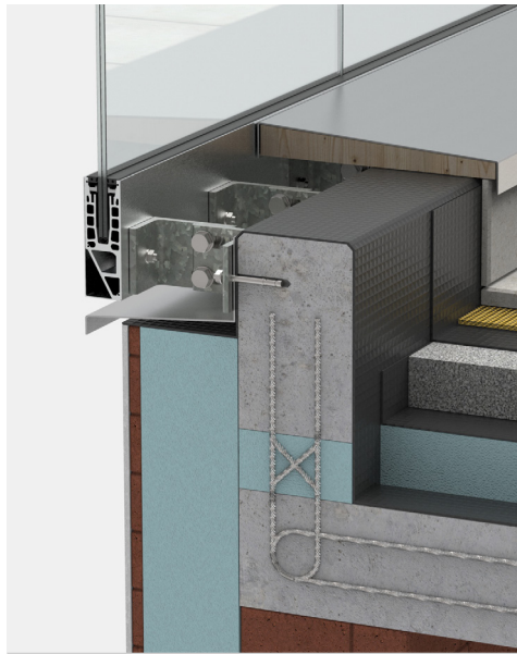
(C) Außenanwendung: Beispiel Balkon-Attika mit Betonelementen gedämmt exterior application: example balcony attica insulated with concrete elements
