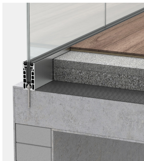
(D) Innenanwendung: Beispiel Empore/Laubengang mit eingelassenem Profil interior application: example porch / portico with recessed profile
