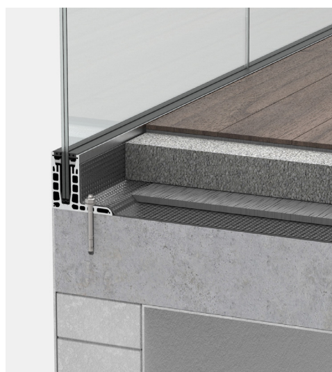
(E) Innenanwendung: Beispiel Empore/Laubengang mit eingelassenem Profil interior application: example porch / portico with recessed profile
